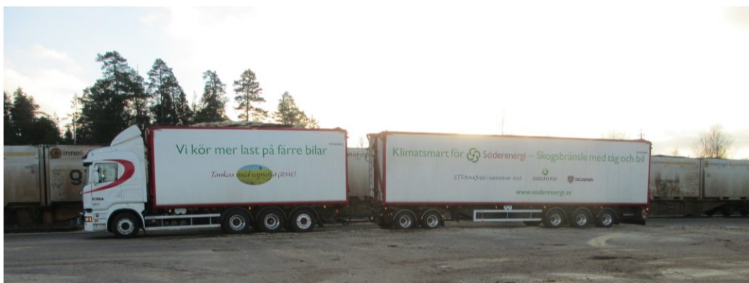
Figur 1. Det ursprungliga försöksekipaget med lastbil, dolly och påhängsvagn. Totallängd 25,25 meter och maximal bruttovikt på 74 ton.
